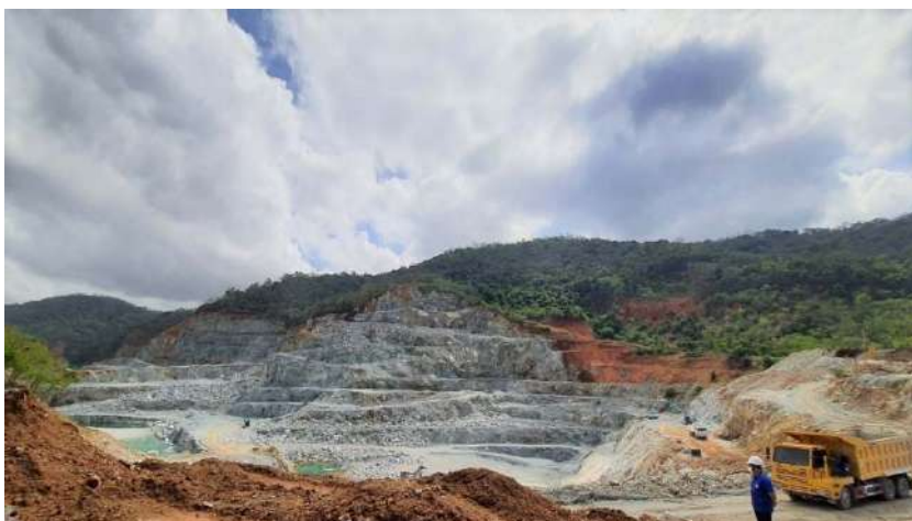
รูปที่ 2: หน้าเหมืองปัจจุบันของโครงการ และการทำเหมืองแบบขั้นบันได
